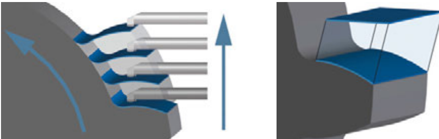
Abb. 2 und 3: Durch die optimierten Mess- und Antaststrategien des Gleitkufen-Tastsystems verhält sich die gekrümmte Oberfläche relativ zum Rauheitstaster wie eine ideale Ebene – hier dargestellt am Beispiel der Profilmessung an einer Evolventenverzahnung.
