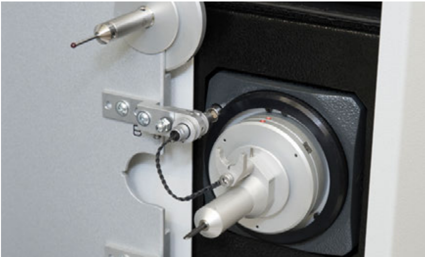
Abb. 1: Rauheitstaster und Steckverbinder: In den sehr kompakten Klingelberg Rauheitstastern ist neben der Sensorik auch eine präzise Schwenkeinrichtung integriert. So können die Rauheitstaster wie die taktilen Taststifte am Wechselteller betrieben und automatisch eingewechselt werden. Besonders komfortabel: der automatisierte Steckvorgang.
